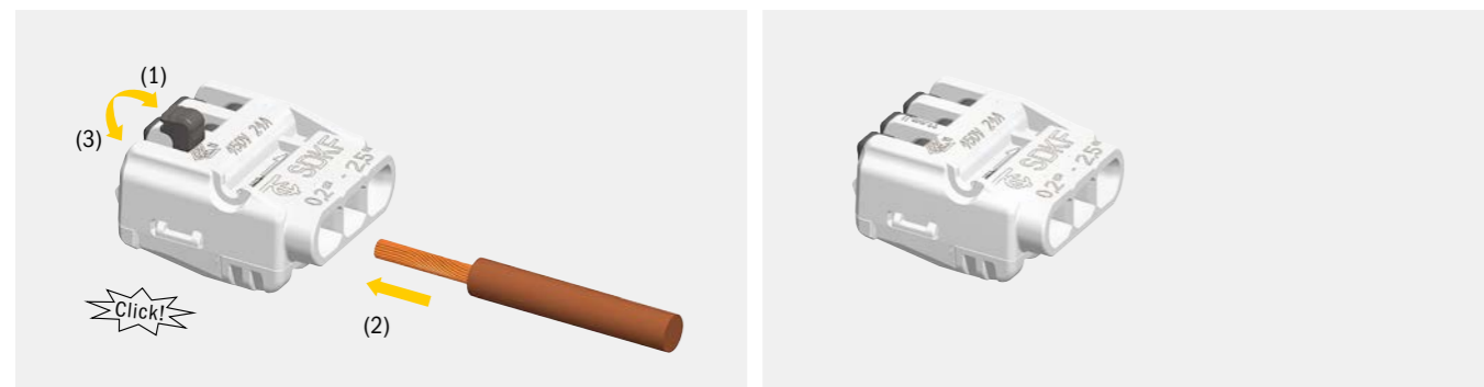
Bei flexiblen Leitern Lösehebel komplett öffnen / schließen For flexible wires open / close the release lever completely
