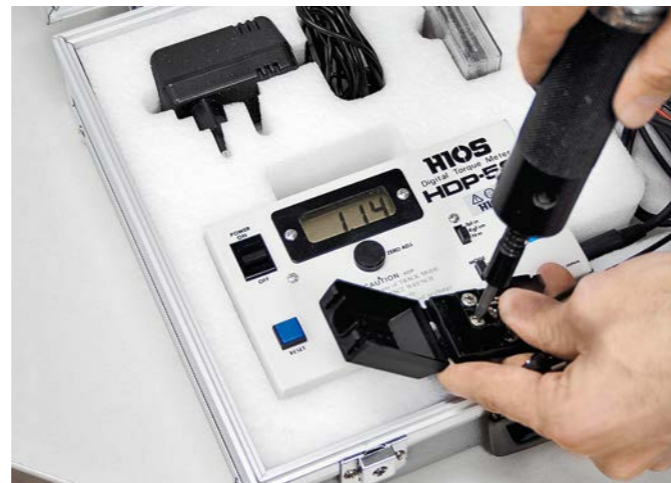
Drehmomentprüfung (KADO) Torque test (KADO)
