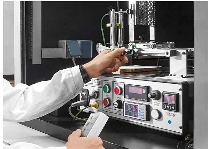
Glühdrahtprüfgerät Glow wire test device
