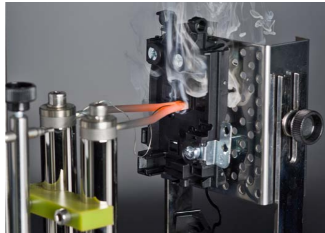
Glühdrahtprüfung (KADO) Glow wire test (KADO)
